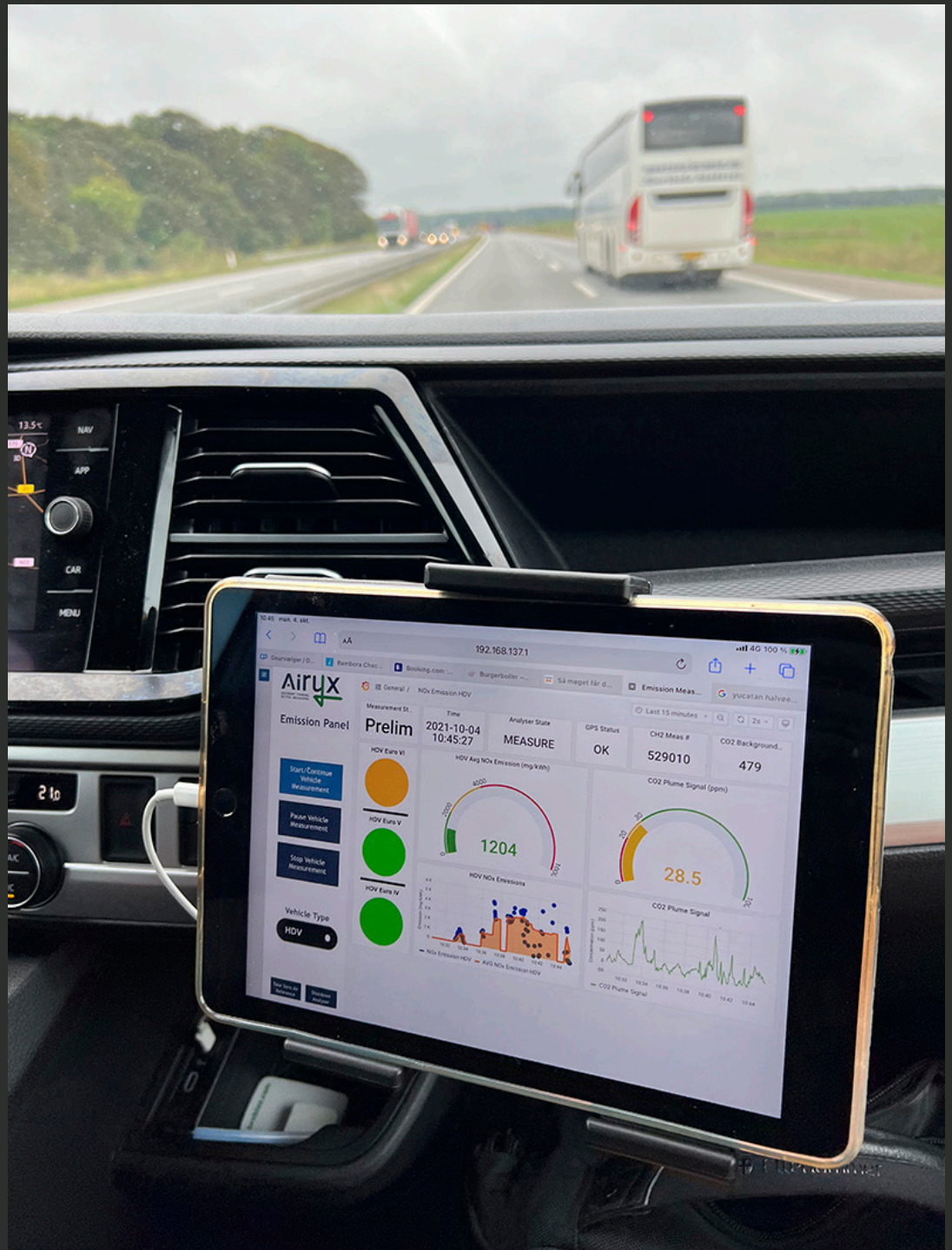
Færdselsstyrelsens bil ligger i den udstødningsky, som køretøjet foran udleder. Her bliver der foretaget en indledende måling og det konstateres om køretøjets udledning er normal eller mistænkelig høj. Hvis det tunge køretøj har en høj udledning, bliver det bragt til standsning til nærmere undersøgelse. Bussen på billedet viser ingen røde udslag efter hverken Euronormerne Euro 4 og Euro 5 samt Euro 6 og blev ikke bragt til standsning
