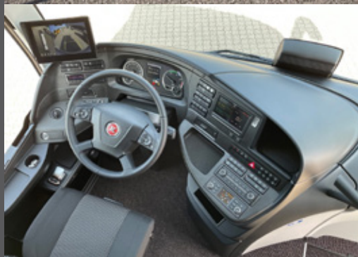
Der er ikke sparet på sikkerhedsudstyret - Bl.a. 360 graders kamera, active drive assist, sideguard assist mm.
